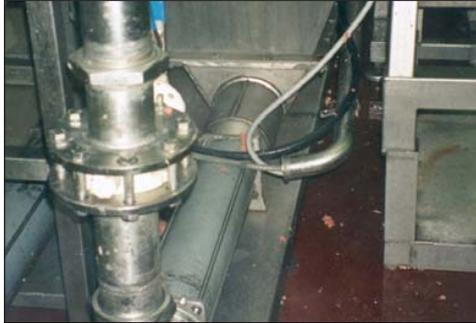
Клиент, производящий мясо, механически отделяемое от костей, которое замораживается перед отправкой производителям пищевых продуктов, установил насос W062 из нержавеющей стали. Мясное филе под действием собственной тяжести попадает во входной накопитель для подачи затем в морозильную камеру. Для эффективной работы морозильной камеры необходима постоянная скорость подачи - 5 тонн в час, чтобы предотвратить простои или задержки в последующих технологических цепочках.
