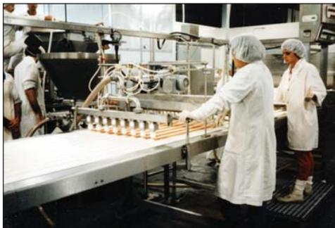
Ведущий разработчик и производитель оборудования для производства тостов, пирожков и сосисок, запеченных в булочку установил насос W032 из нержавеющей стали на установку по производству запеченных сосисок. Для постоянной подачи подготовленного мясного фарша на заданную длину в оболочку из теста со скоростью 5-10 куб. м/час насосы серии W должны иметь систему шнековой подачи, которая обеспечит непрерывную подачу мясного фарша из широкой горловины в рабочий узел насоса.
